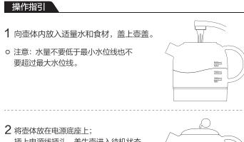
插上电源线插头,养生壶进入待机状态。 o 注意: 待机状态下显示屏显示水的当前温度;
