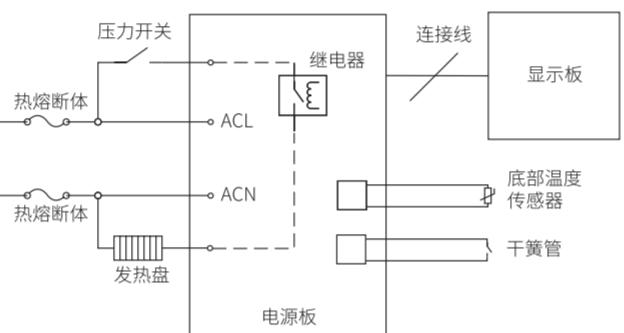
备注：软件评估的机器火线上无热熔断体
